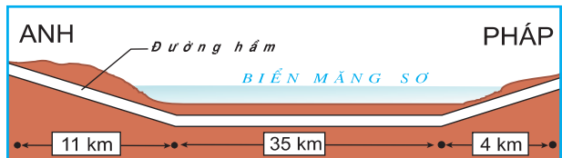
Hình 7.8. Sơ đồ đường hầm giao thông dưới biển Măng-sơ.
