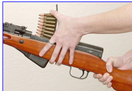
Hình 4-46. Lắp kẹp đạn vào súng
