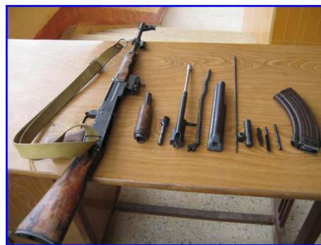
Hình 4-28. Thứ tự các bộ phận khi tháo xong (từ phải qua trái).
