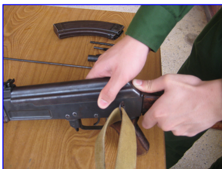
Hình 4-24. Tháo nắp hộp khoá nòng.
