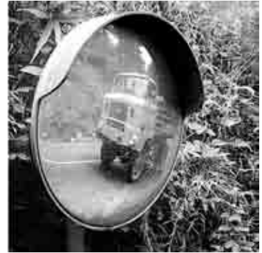
Hình 48.24 Gương cầu lồi đặt ở đoạn đường cong nguy hiểm.
