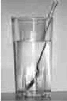
Hình 26.1 Do hiện tượng khúc xạ ánh sáng, ta thấy thìa trong cốc như bị gãy ở mặt nước.
