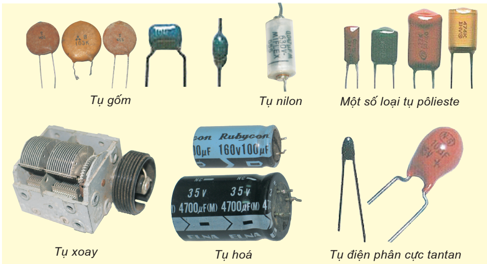
Hình 2 – 3. Hình dạng một số loại tụ điện
